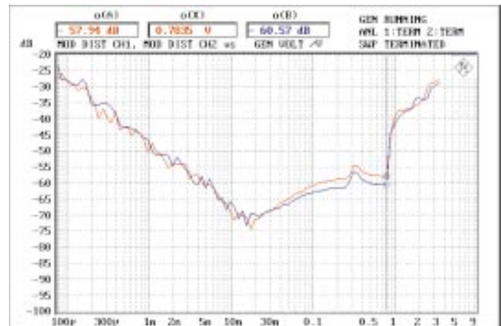
Abb. 10: Modulationsverzerrungen nach SMPTE (60 Hz und 7 kHz) und 2 \times 4 Ohm Last (CH1, CH2)
